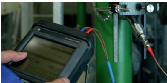
Abbildung 4: Eine der Ultraschallsonden, die die Durchflussdaten an das mobile Messgerät übermitteln.
