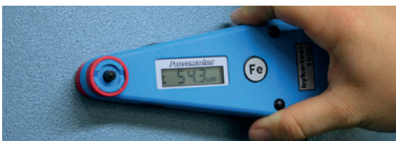
Abbildung 7: Schichtdickenmessung auf einem eisenhaltigen Untergrund (siehe Fe-Kennzeichnung).
